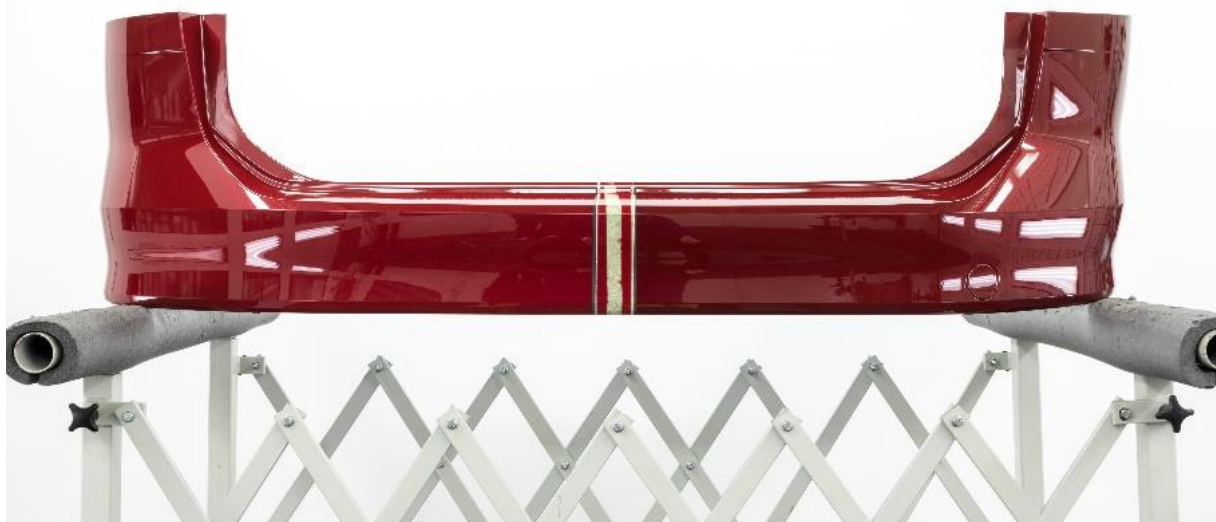
Die fahrerseitig mit Lackhersteller A (linke Bildhälfte) und beifahrerseitig mit Lackhersteller B (rechte Bildhälfte) in VW Chili Red (LS3M) lackierte Heckstoßfängerverkleidung zeigt deutliche Farbtonunterschiede bei Verwendung der Standard-Mischformel.
