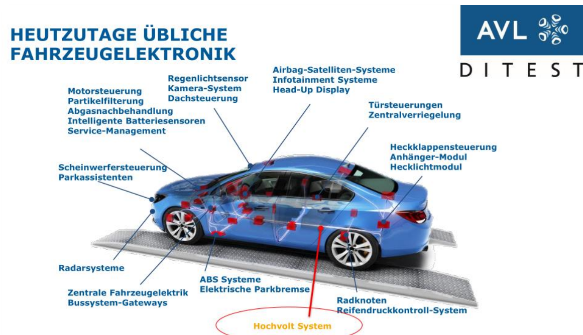
Ein kleiner Auszug heute vorhandener Elektroniksysteme im Fahrzeug. (Bild: AVL DiTEST)
