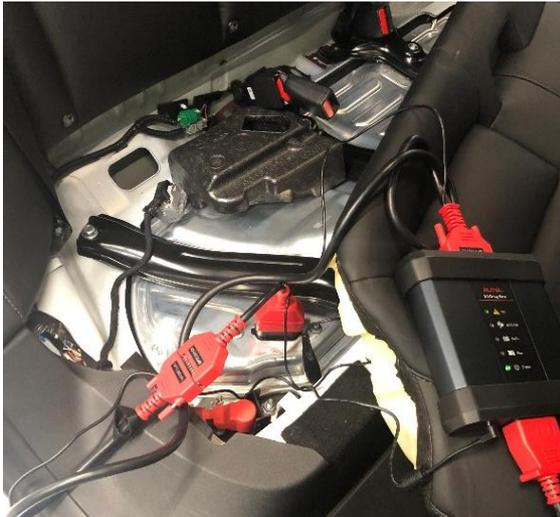
*Neben dem OBD-Zugang lassen sich die Batteriedaten durch geeignete Adapter auch direkt an der HV-Batterie abgreifen.*
